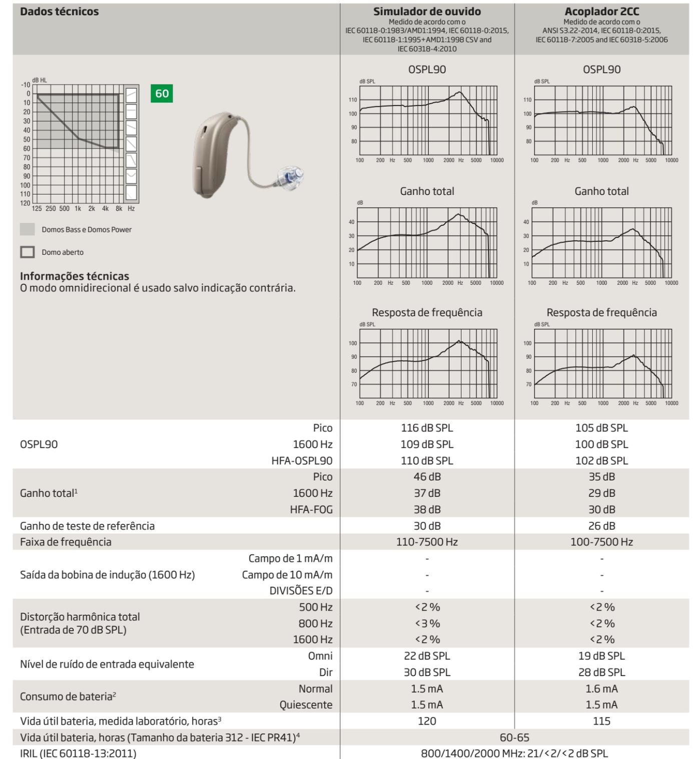
1) Medidas com controle de ganho do aparelho auditivo definido na posição Ganho Total menos 20dB e com SPL de entrada de 70dB. Esta é a resposta obtida do ganho igual ao ganho de resposta completa, por exemplo, a partir do IEC 60118-0+A1:1994 sem influência de feedback.
