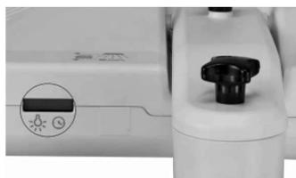
Figure 2-5 : Temporizador da vida útil da lâmpada
